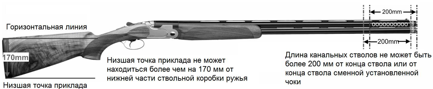
Низшая точка приклада или пяты затыльника приклада не может быть расположена ниже, чем на 170 мм, если мерить от горизонтальной линии, проходящей от нижней части ствольной коробки (см. иллюстрацию).
